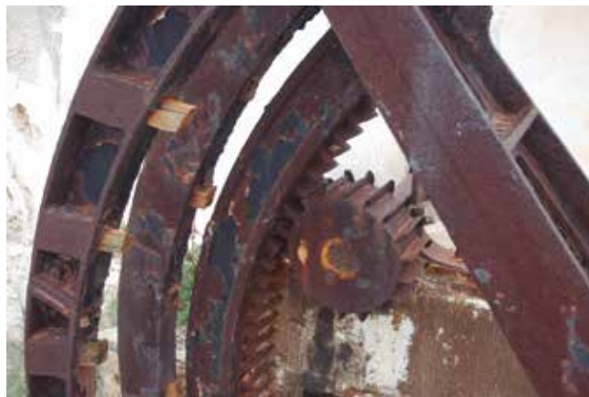
Detall de l'engrana de la roda de pales de la Màquina d'en Palla, Formentera (AFA).
