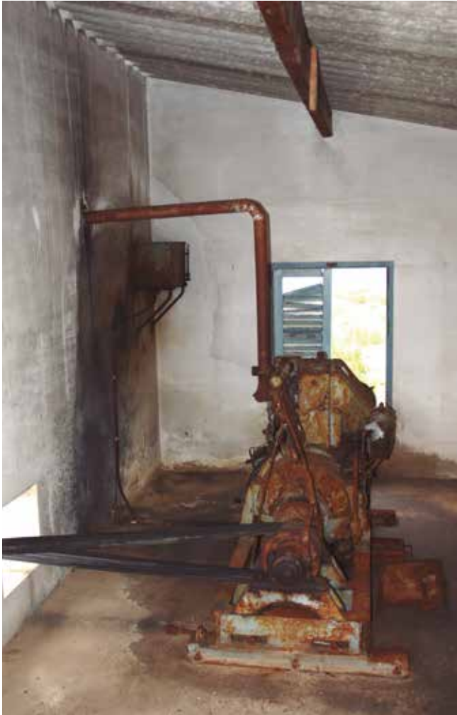
Moto-bomba que va substituir la Màquina d'en Palla, ses Salines, Formentera (AFA).
