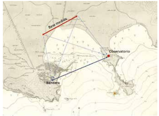
Ilustración de la base medida al norte del puerto de Ibiza y de la base obtenida a partir del observatorio de la isla Plana y de la bandera del baluarte de Santa Tecla, sobre un portulano de 1740
